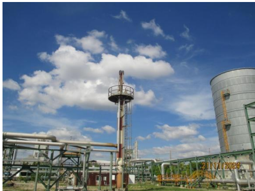
รูปที่ 3.2-4 Low Pressure Flare
